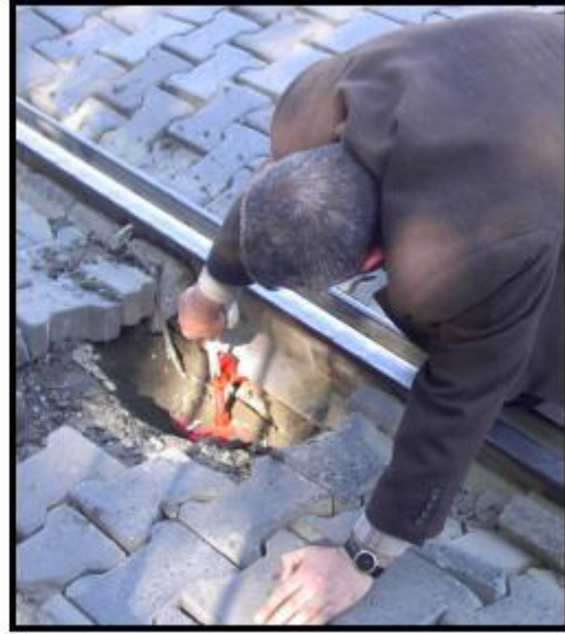
Resim.19.GB5 ile oluklu rayda yapılan bir ölçüm Çalışması
