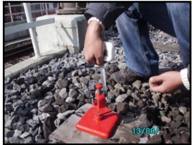
Resim.20-21 GB5 ile Mantar rayda yapılan bir ölçüm çalışması
