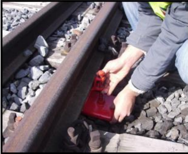
Resim.20-21 GB5 ile Mantar rayda yapılan bir ölçüm çalışması
