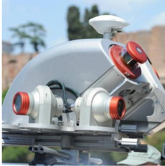
Şekil 1. MLS sistemi, kameralar, tarayıcı ve GNSS sistemi
