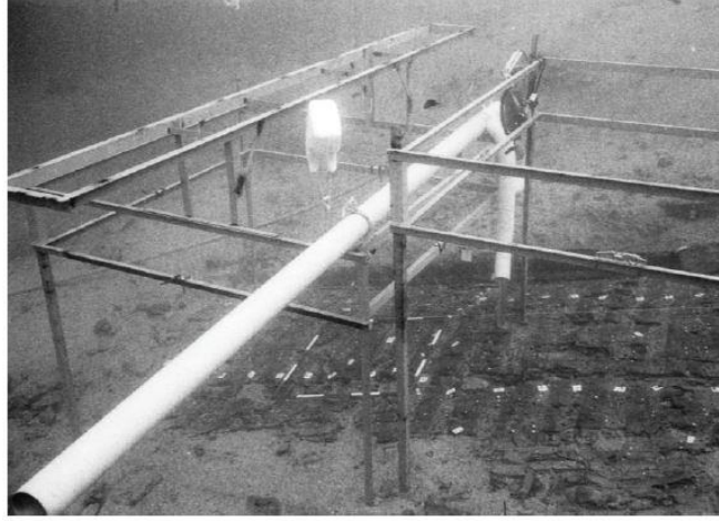
Şekil 3: Dramont batığına fotogrametrik olarak çalışabilmek için kullanılan metal çerçeve
