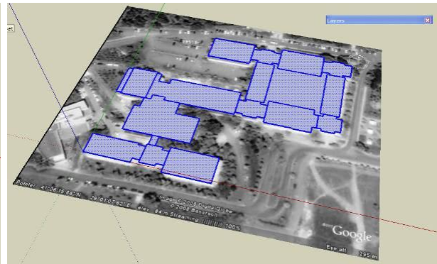
Şekil 6: Fakülte binasının 2 Boyutlu taban modeli (tek ve çoklu blok dizaynları)
