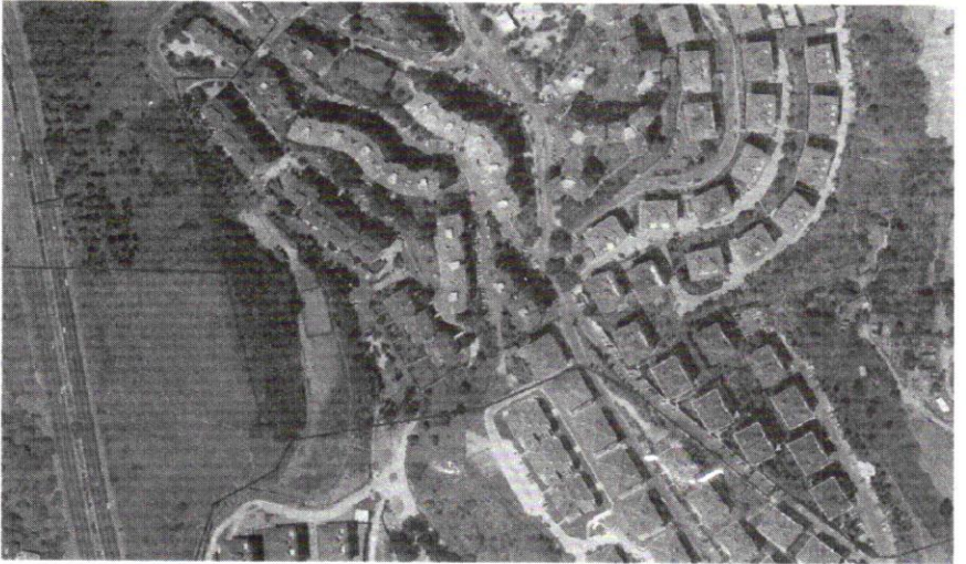
Şekil 6. Radyometrik Düzeltme Uygulanmamış Ortofoto
