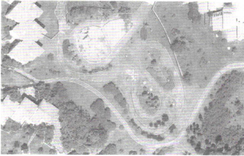
Şekil 10. Açık Arazide Oto korelasyon İle Üretilen SAM'in Kıymetlendirme Operatörünün Derlediği Sayısal Harita İle Uyumlu Olduğu ve Doğru Ortofoto Elde Edildiği Görülmektedir.
