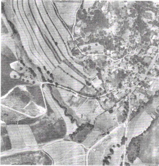
Şekil 14. Otomatik Korelasyon Metoduyla Elde Edilen ve Gerekli Düzeltme Aşamalarından Geçen SAM ile Üretilen Ortofoto.
