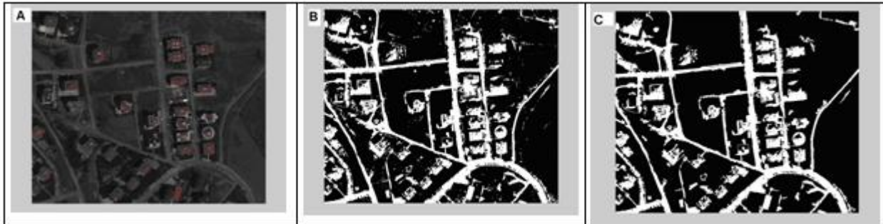
Şekil 3. RGB görüntünün matlab ortamında analizi a: RGB Girdi verisi; b: Siyah/beyaz format; c: Eşik değeri uygulanmış veri
