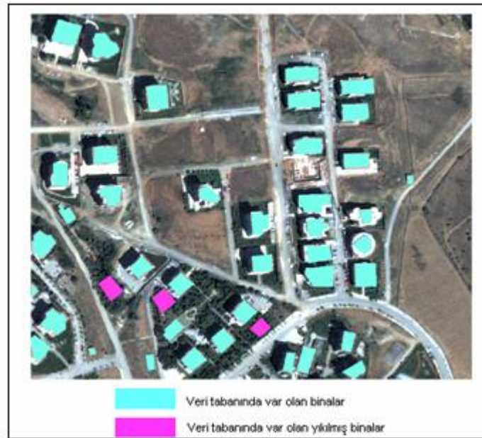
Şekil 8: Yıkılan Binaların Bulunması
