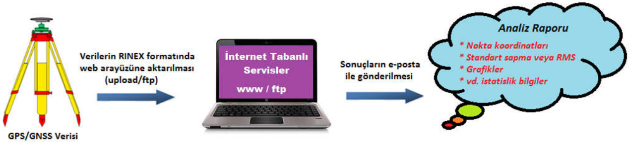
Şekil 1: İnternet tabanlı konum belirleme servislerinin temel çalışma sistematiği (Öcalan ve Soycan, 2012)
