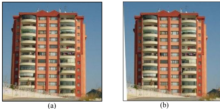
Şekil 3: Örnek bir binanın (a) geometrik rektifikasyonu yapılmadan önceki ve (b) yapıldıktan sonraki görüntüleri
