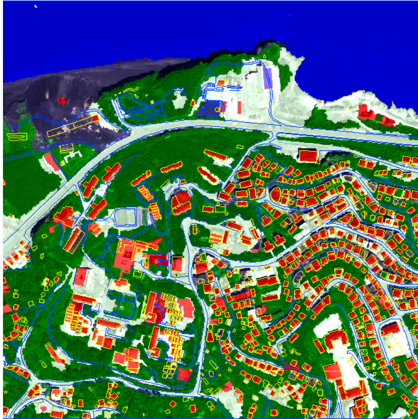
Şekil 7: Nesne-tabanlı sınıflandırma sonucu ile vektör haritanın çakıştırılmış hali (Sarı çizgiler vektör haritada bulunan binaları, mavi çizgiler de yolları ifade etmektedir)
