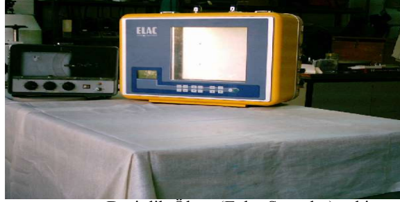
Şekil 3: Derinlik Ölçer (Echo Sounder) eski ve yeni
