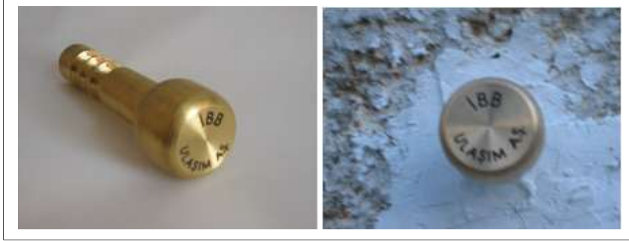
Şekil 3. Bölgede Tesis Edilen Nivelman Noktaları
