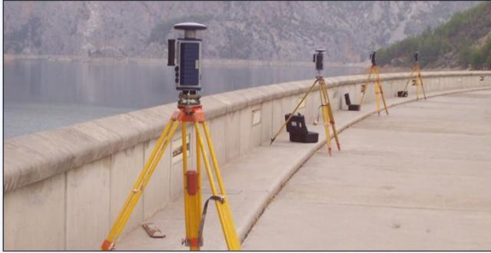
Şekil 5: Baraj kreti üzerindeki GPS nivelmanı ölçmeleri
