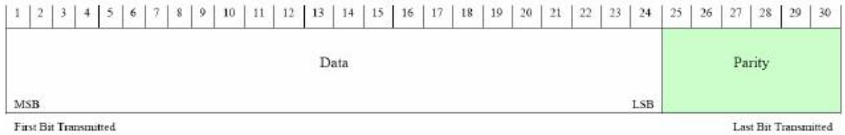
Şekil 9: RTCM 2.x için 30 bit'lik kelime yapısı (Heo vd., 2009)
