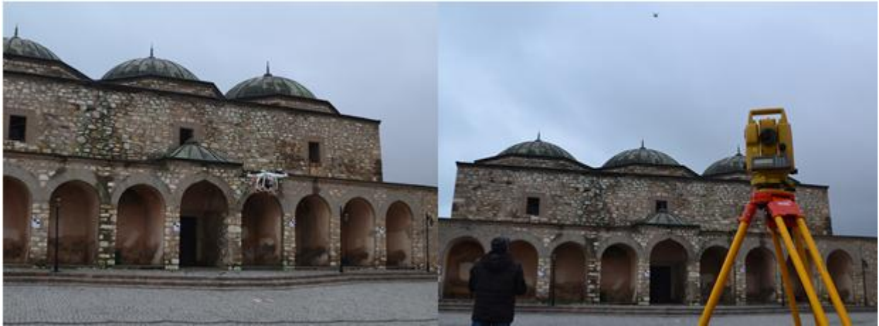
Şekil 4. Havadan cephe (sol) ve çatı (sağ) fotoğraf çekimi için İHA' nın kullanılması.
