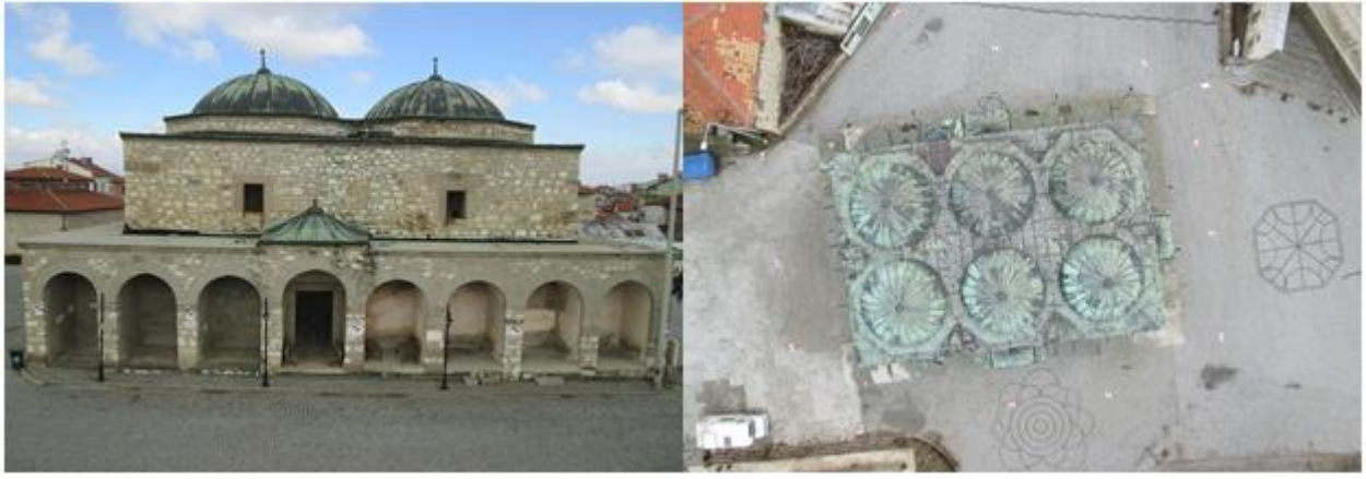
Şekil 5. Fotogrametrik değerlendirme için İHA ile çekilen havadan cephe (sol) ve çatı (sağ) fotoğraflarına bir örnek.
