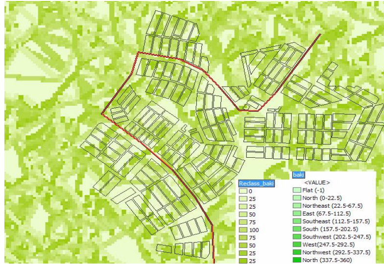
Şekil 4.9: Yeniden sınıflandırma edildikten sonra puanlama yöntemine göre manzara bakı faktörünün değer haritası.
