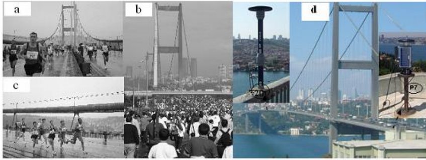
Şekil 6: Maraton koşusu kapsamında ortaya çıkan farklı yükler (a-b-c) altında 20 numaralı noktanın P7 numaralı referans noktasından RTK-GPS ile ölçülmesi (d)
