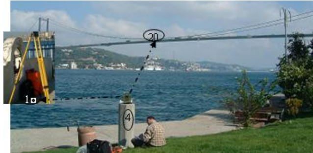
Şekil 4: 20 numaralı noktanın 4 ve 1 numaralı referans noktalarına bağlı olarak TCA2003 ile ölçülmesi
