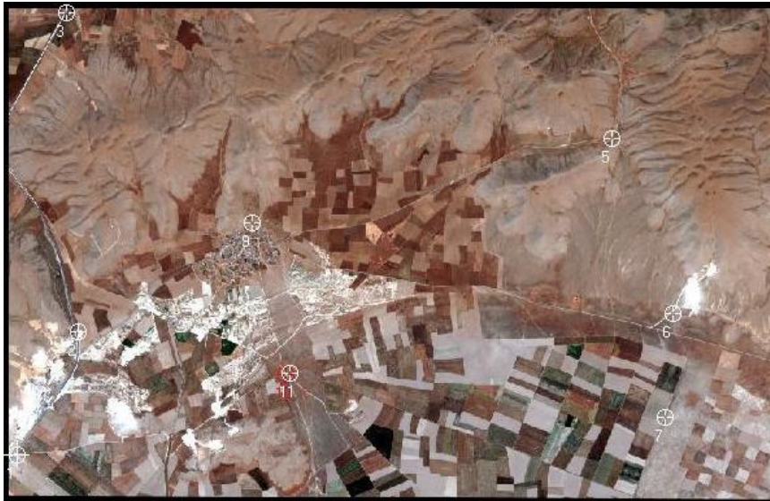
Şekil 2: Görüntü üzerinde yer kontrol noktaları dağılımı
