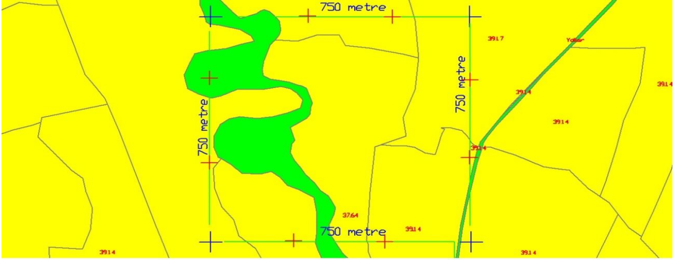
Őekil 3: Daphan Ovası, toprak endeksini belirlemek iin aılmıř sondaj kuyuları
