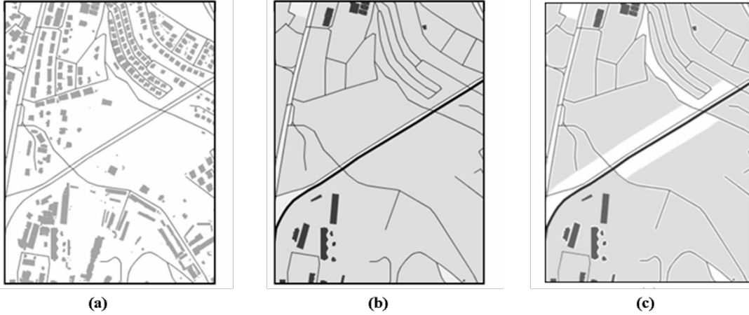
Şekil 6: Alan genelleştirme örneği: a) Orijinal veri. b) Mevcut yöntemler ile sınıflandırılmış gösterim. c) Önerilen yöntem ile sınıflandırılmış gösterim.
