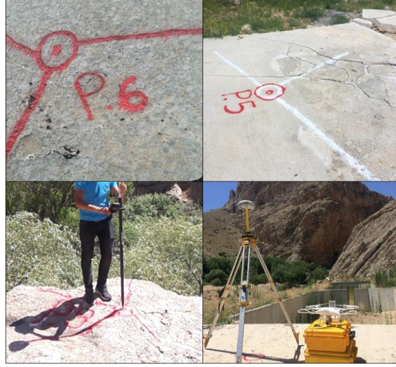
Şekil 2. Yer Kontrol Noktalarının işaretlenmesi ve alımda kullanılan cihazlar
